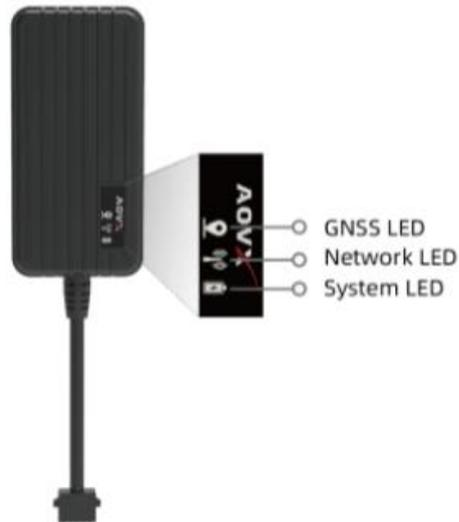
Figura 5: Indicador dos LEDs
